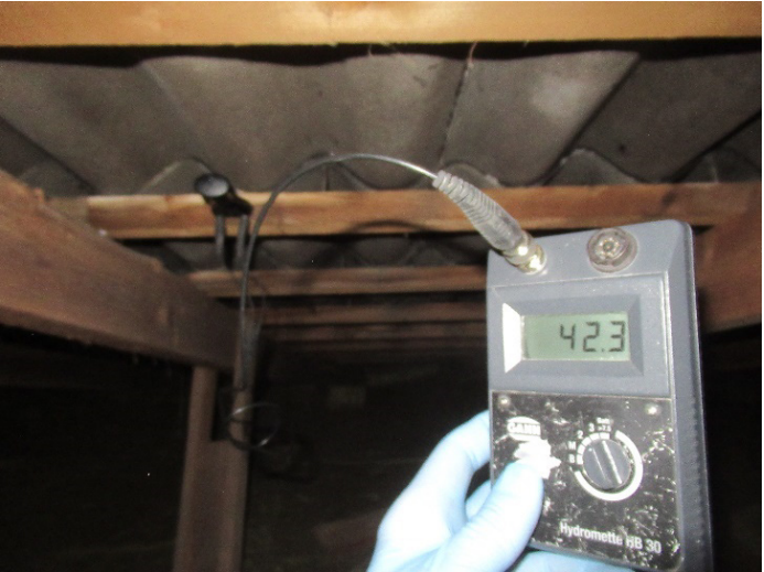
Eksempel meget høj træfugt i lægter.
