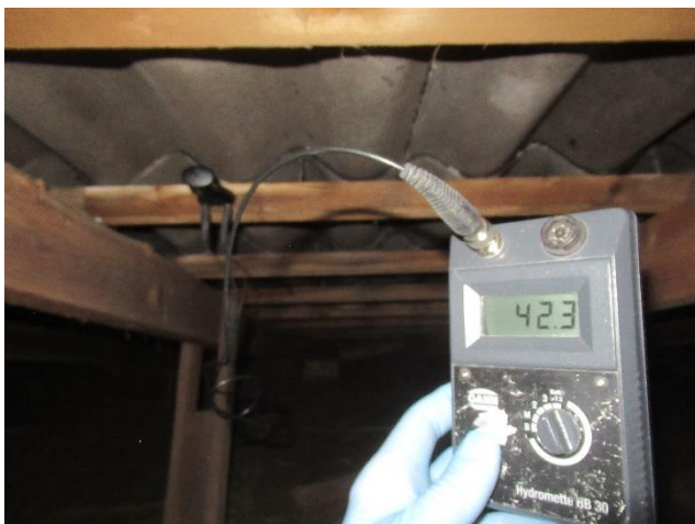
Eksempel på opfugtede lægter i nr. 25.
